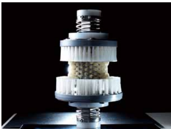
車いすの自動洗浄機開発の 大きな転換点となった洗浄ブラシ (現行製品のもの)
