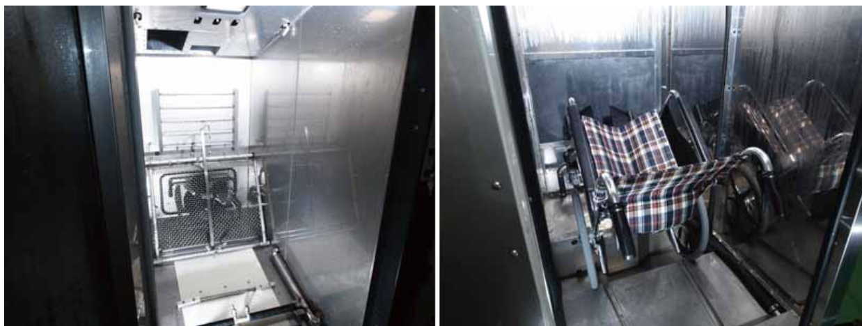
リフレッシャー Pro の庫内（左）、リフレッシャー・ライトは正立位置でも洗浄可能（右）
