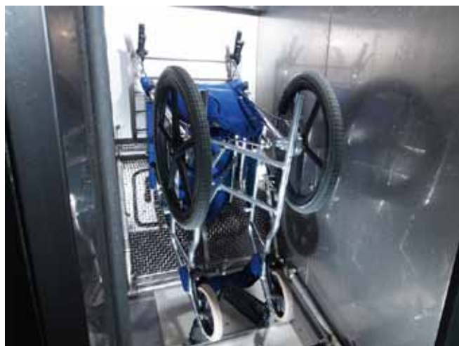
自動洗浄機に車いすを俯せにセットしたところ (写真は現行製品のもの)
