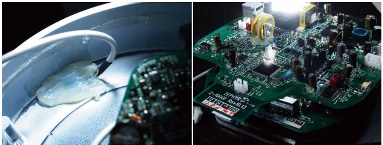
強風時にかけるブレーキによる筐体内の温度上昇を監視するセンサー（左）、 微風から強風まで自ら考えて発電するエアドルフィンの制御基板（右）
