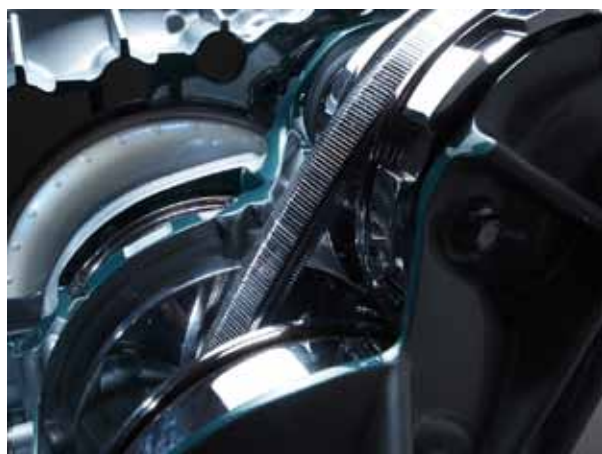
プーリとベルト。 左下側のプーリがエンジンにつながっている (CVTのカットモデル)
