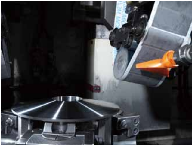
フィルムラッピング工法にて表面を研磨
