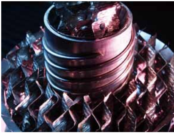
木村化工機の蒸留塔研究開発のノウハウが 結集された HiDiC 用二重管
