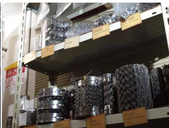
現在使用されている充填物（左）と、試作品の一部（右）
