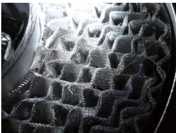
当初、実験に使用していた網状の充填物
