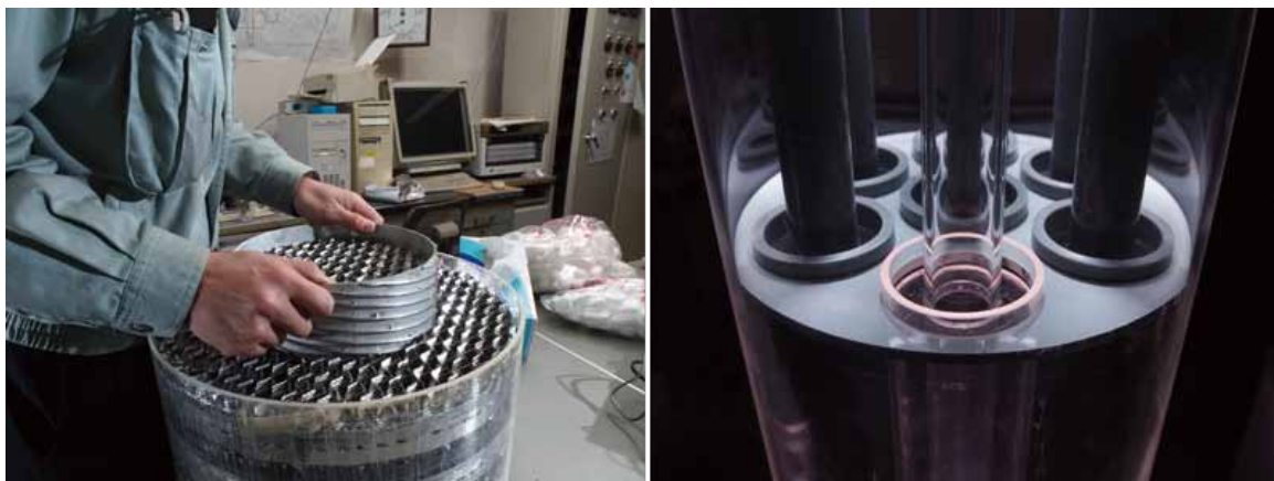
商用機用の二重管のサンプル（右）、HIDiC の塔内部構造の模型
