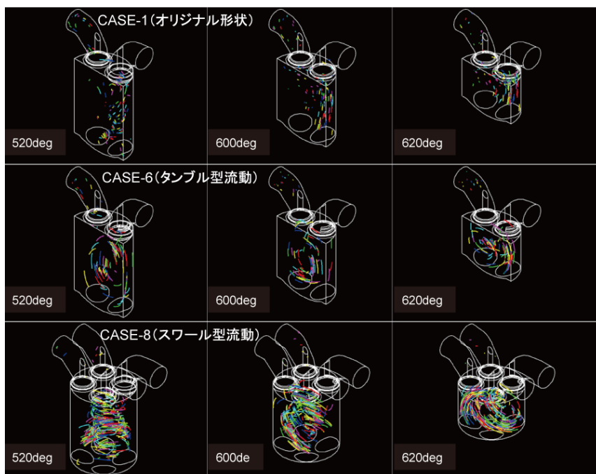
図6 吸気通路の形状検討例
