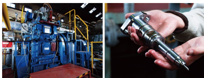
岡山県玉野市の事業所内に設置された 研究開発用の単気筒試験機（左）、 効率アップのカギの一つとなった噴射弁（右）
