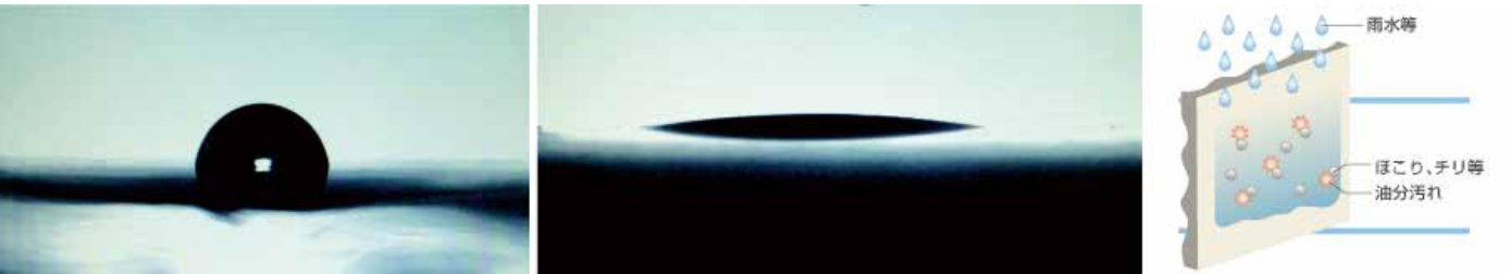
図1(左)光照射前の撥水状態、(中央)光照射による超親水状態、 (右)超親水状態では、塗料表面のチリ、ホコリが、雨水によって流されます。
