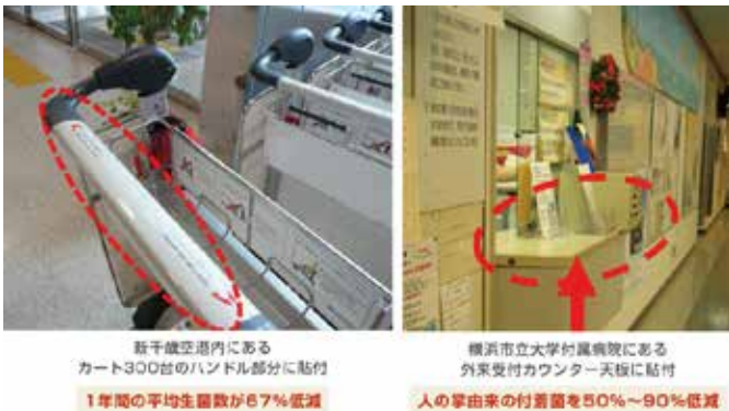
図11 パナソニックの可視光応答型光触媒フィルムの 実証試験とその効果
