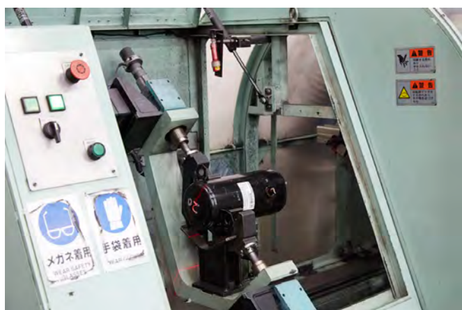
コンプレッサーを専用の機械で切断することでレアアースを回収している
