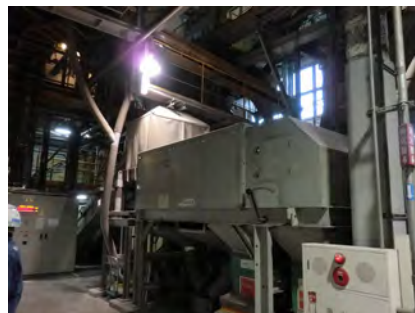
非鉄金属を回収する渦電流選別機 (提供:東京エコリサイクル株式会社)
