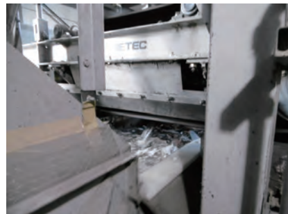
家電リサイクルを一連の流れで効率良く行うために最適化された磁力選別機 (提供:東京エコリサイクル株式会社)
