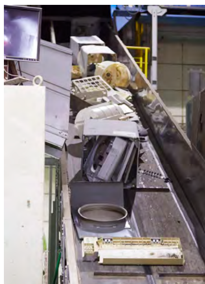
磁石の力を利用して鉄を選別する磁力選別機 磁力選別機(提供:東京エコリサイクル株式会社)
