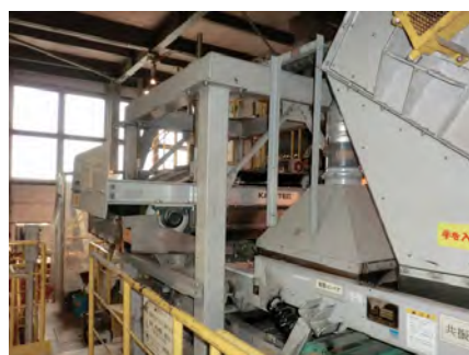
磁石の力を利用して鉄を選別する磁力選別機 磁力選別機(提供:東京エコリサイクル株式会社)
