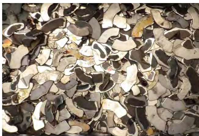
HDDから回収されたレアアース磁石 (提供:東京エコリサイクル株式会社)
