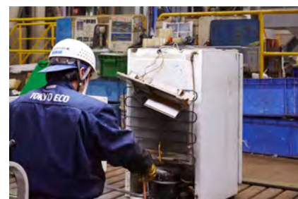
手作業によって冷蔵庫を解体している様子
