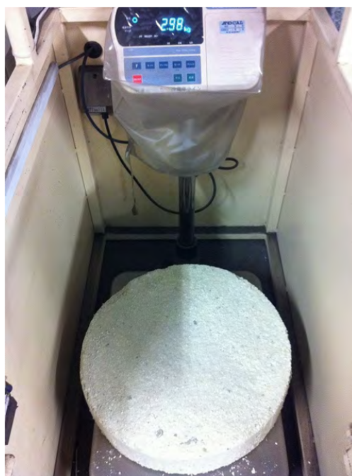
破碎してフロンを回収した後に圧縮されたウレタン (提供:東京エコリサイクル株式会社)
