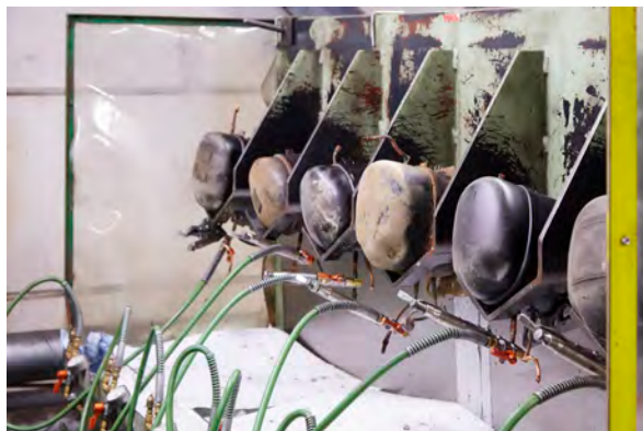
コンプレッサーから冷媒フロンを回収している様子
