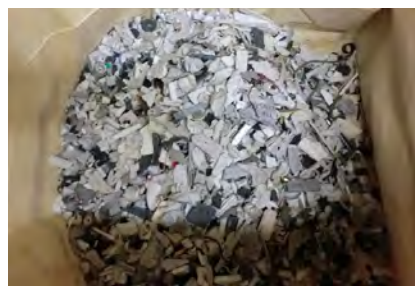
回収されたプラスチック。東京エコリサイクルでは、独自の技術として二段風力選別機を開発し、ウレタンとPVC類を混合プラスチックから除去(選別)している (提供:東京エコリサイクル株式会社)
