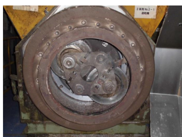
破砕機(左)で破砕後、造粒機(右)で圧縮固化され造粒プラスチックに加工 (提供:JFEスチール株式会社)
