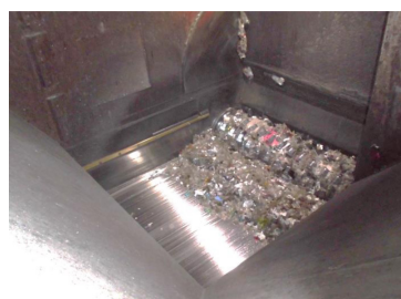
破砕機(左)で破砕後、造粒機(右)で圧縮固化され造粒プラスチックに加工 (提供:JFEスチール株式会社)
