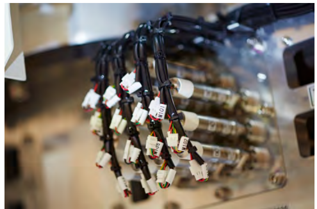
MLCを構成する鋼を1枚ごとに独立して制御(右)することで、照射口(左)で放射線の形を調整している
