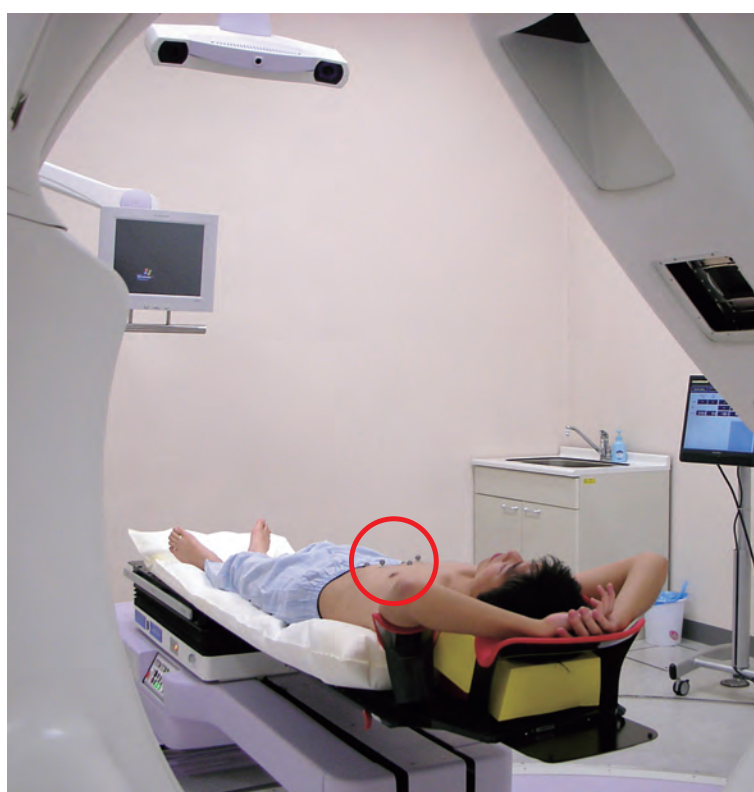
胸の上に設置された赤外線マーカー（赤丸内）の上下の動きを探知することで呼吸信号を読み取る (提供:三菱重工業株式会社)
