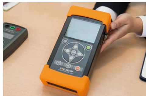
図9 断線と地絡とを1台で推定できる新製品「SOKODES GF（ソコデスGF）」
