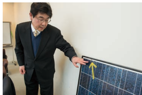
図1 ほんのわずかな断線で故障した太陽光パネル
