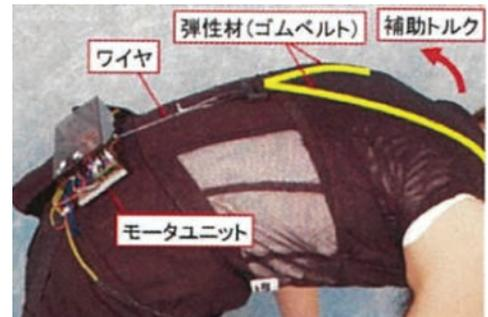
図1 一部に外部動力を用いるプロトタイプ0号
