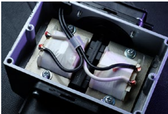
ダイヤフラムを動作させる電磁石が入ったブロワ内部
