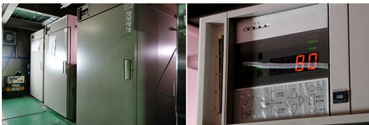
（左）補機プロジェクトで加速試験用に導入された3台のオーブン（右）温度設定パネル
