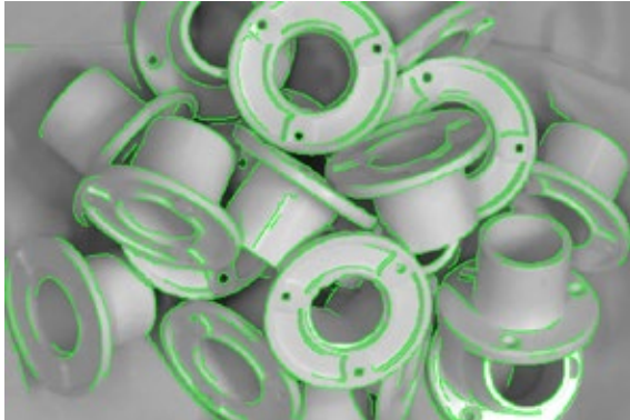
図2 「TVS」による部品の3次元（輪郭）計測 （画像提供・三次元メディア）
