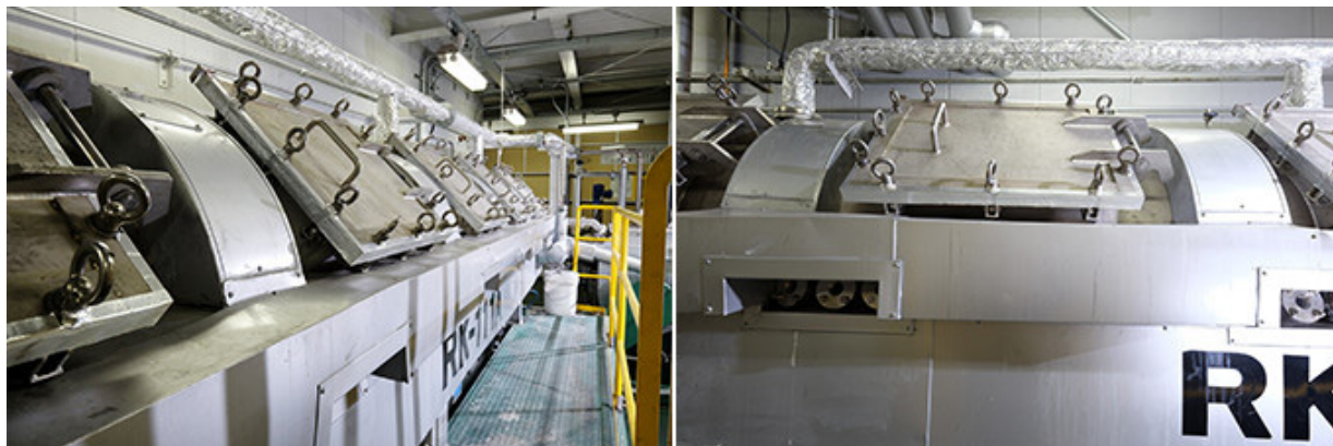
写真3 同社住之江プラントのリアクター(左)、リアクターの各槽は反応の順に傾けて配置されていて、次の槽へと溶液が自然と流れ込むように設計されている(右)
