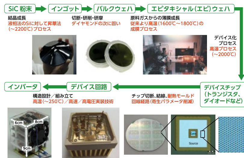
図 4 SiC 材料からインバータ成立に至るまでの研究プロセス (資料提供：産業技術総合研究所)
