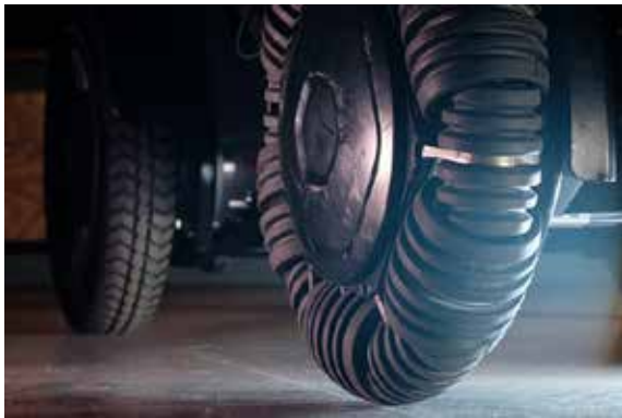
写真 2 WHILL の車輪、前輪が WHILL オリジナルの「オムニホイール」
