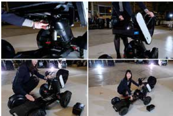
写真 7 簡単に分解や組み立てが可能な「Model C」
