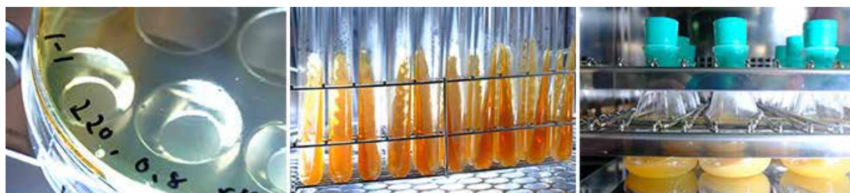
写真 2 磐田化学工業での「耐熱性酵母」の培養試験。（左）シャーレに菌を蒔き生育状況を見て特徴のある株を選び出し、（中）試験管にコロニーを単離して培養後、（右）フラスコによる液体培養試験で特性を評価する
