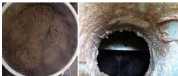
写真7 （左）連続加熱後のキャッサバパルプスラリー、（右）点検口から確認された蒸留塔内部の汚れ状況 （写真提供：サッポロホールディングス）
