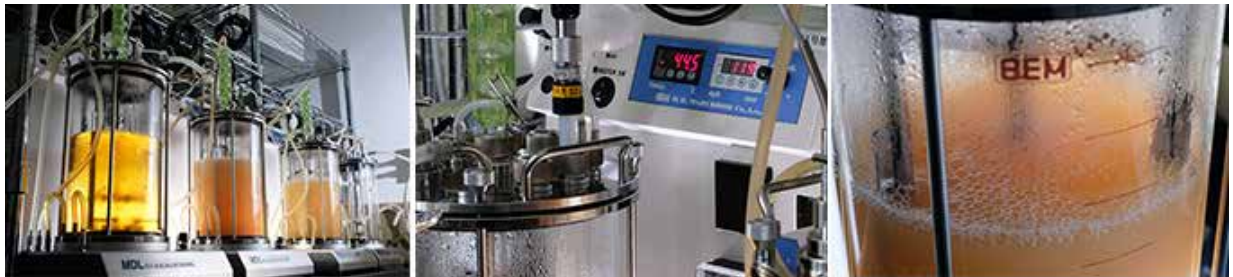
写真9 磐田化学工業では「耐熱性酵母」の大量供給に向けて培養評価の研究が続く。（左）生育環境を変えての評価（培養温度と攪拌速度がそれぞれ異なる）、（中）40℃を超える発酵温度、（右）培養が進んで濁る容器、「耐熱性酵母」は培養速度が速いのが特色
