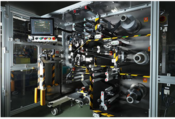
写真3 開発実証段階の巻回装置。シート状の電極やセパレータを高速で巻いていく
