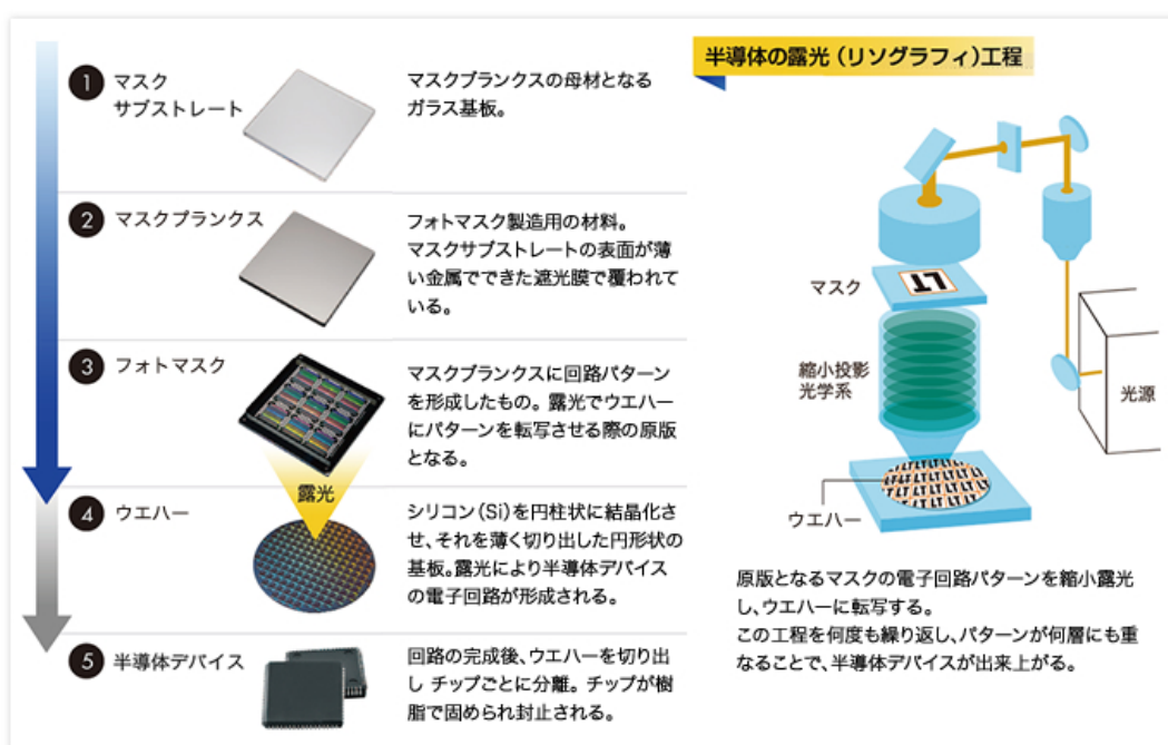
図1 半導体デバイスは①～⑤の工程を経て製造される（資料提供：レーザーテック）
