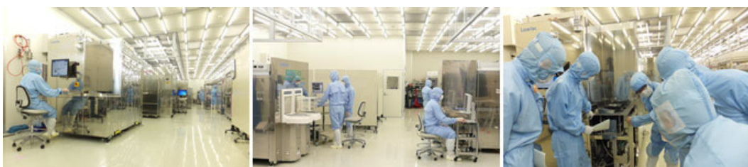
写真3 レーザーテックの開発現場は、半導体製造のクリーンルーム同様に最高レベルの清浄度が保たれている（写真提供：レーザーテック）
