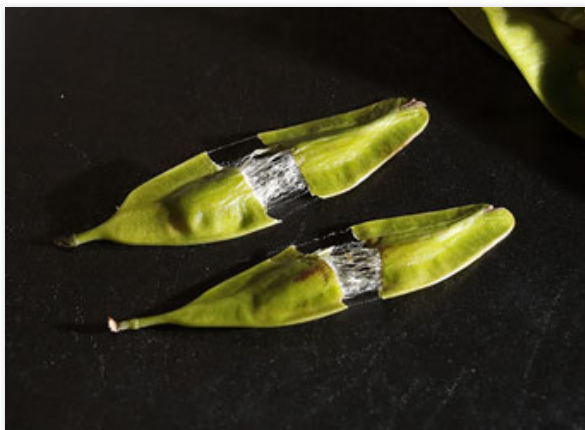
写真2 杜仲の種子に含まれる白色糸状の物質がTPI（トランス型ポリイソプレン）
