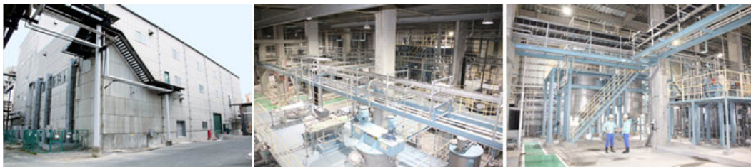
写真5 （左）新聞古紙パルプの製造建屋（4,700㎡）を有効利用した石巻工場の外観。（中央、右）2Fの量産設備で反応・洗浄・除塵・解繊処理などが行われている（写真提供：日本製紙）
