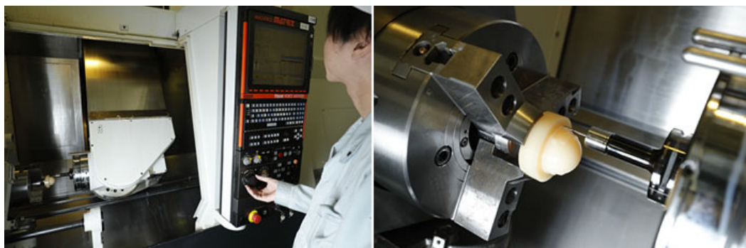
写真6 樹脂成形品を熱処理する機械。摺動部材の成形では「直接圧縮成形」と呼ばれる手法により、1工程で完成品に近い形状を成形する。操作盤と成形部（左）、成形部の拡大（右）
