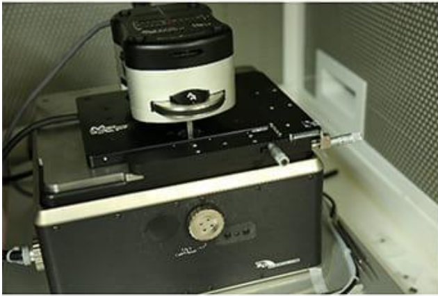
写真1 (左)今回の開発に貢献した原子間力顕微鏡(AFM) (右)AFMの計測に使用するサンプルとホルダ
