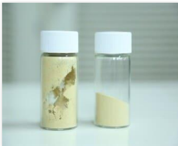
写真3 触媒を入れて練った砂（左） 触媒をコーティングした砂（CCS）（右）
