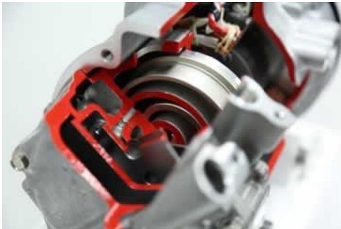
写真3(左) コンプレッサのカットモデル (中央にあるのが渦巻き状のスクロール)
