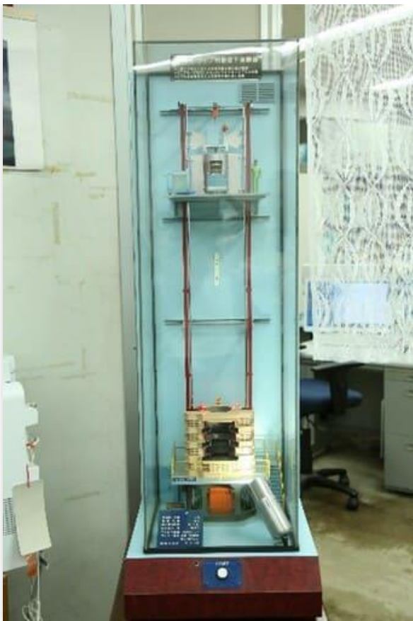
写真1 北海道の微小重力実験装置の模型 上から落下させながら火炎の測定を行うことで、人為的に微小重力状態をつくり、浮力の影響を受けないようにする。
