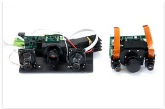
写真1 3Dビジョンセンサーの初号機（左）と大幅に小型化、性能UPされた「YCAM3D」（右）の実機比較
