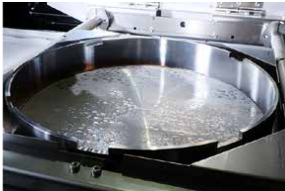
写真 1 1 層分だけパウダーベッドに敷き詰められた金属粉末材料。直径 260mm
