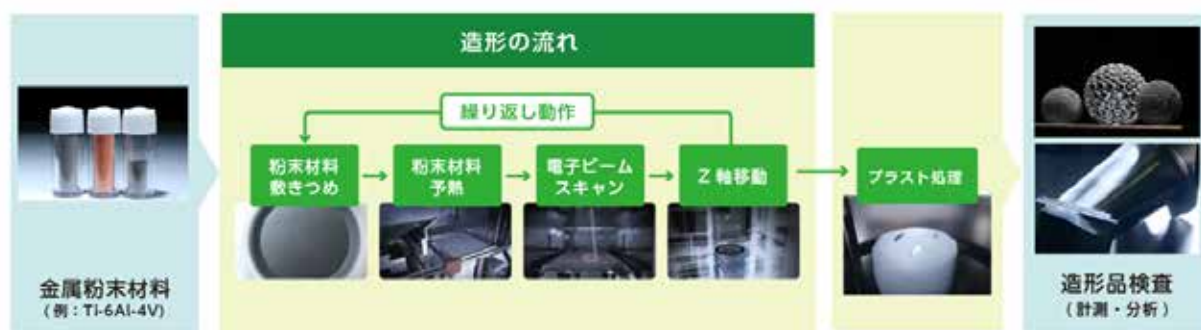
図 3 電子ビーム金属積層造形の流れ（資料提供：日本電子）
