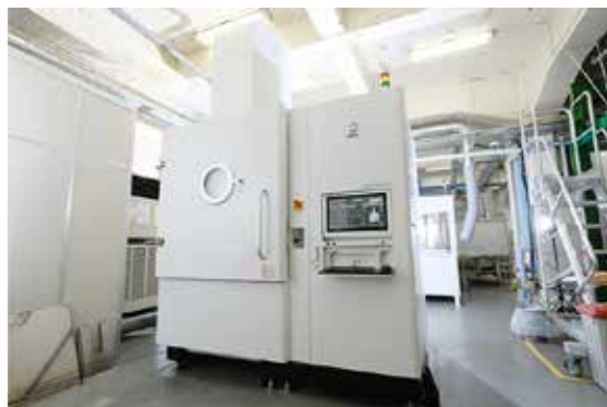
写真 6 日本電子が開発した電子ビーム金属 3D プリンター「JAM-5200EBM」
