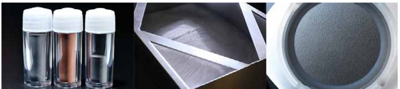
写真 8 「JAM-5200EBM」に使用されている金属粉末 粉末種類（左） 電子ビーム金属 3D プリンターの金属粉末収納部（中） 材料容器に入った金属粉末材料（右）
