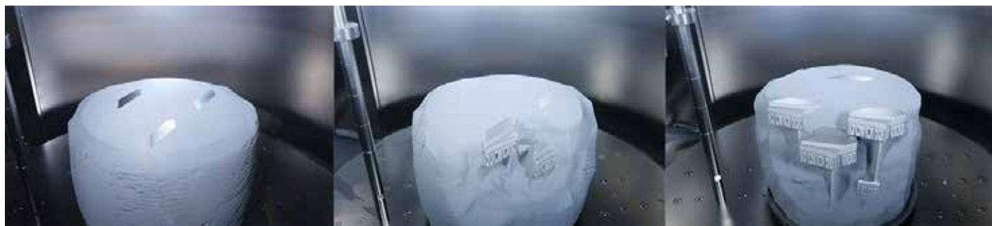
写真 3 仮焼結体で覆われた造形物（左）。仮焼結体を除去していくと、次第に完成品がその姿を現してくる（中央と右）
