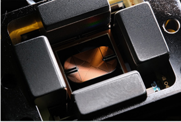
写真2 小判状のミラー可動部と周囲の磁気回路から構成された部品が日本信号の開発したMEMS光スキャナ「ECO SCAN」。左右を突き通す棒のような部分を軸に、電磁力で中央部のミラーが“動く”（振動する）。単結晶シリコンによる一体形成で摺動部がなく、耐久性に優れ長寿命
