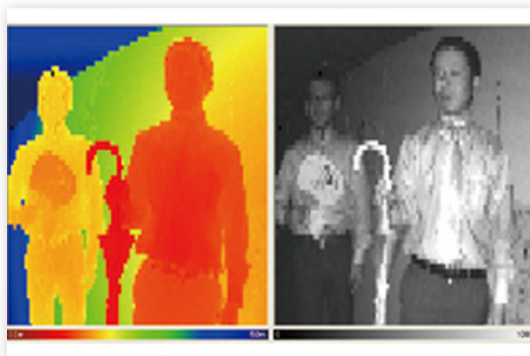
図11 スキャン結果のイメージ。右は光量画像で、左が距離画像、赤色が濃いほど距離が近い（資料提供：日本信号）
