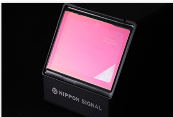
写真5 自己健全性モニタを搭載する最新型「アンフィニソレイユFX10s」。正面ガラスの右下の三角形が自己健全性チェックのために貼られた特殊シール
