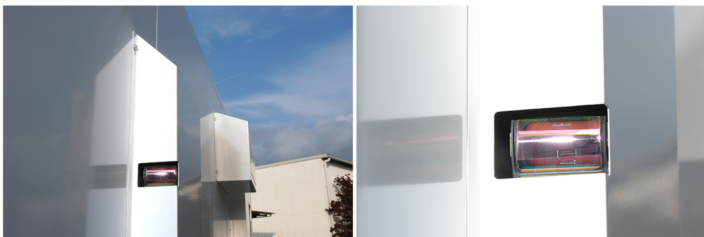
写真3（左）ホームドアに実装された「アンフィニソレイユ」。（右）欠き取り部分に配置されている。日本信号宇都宮事業所の試験エリアで、普段は見ることもできない電車の走る線路側から撮影
