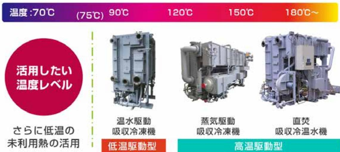
図3 従来の熱駆動型吸収冷凍機の駆動温度帯。従来の吸収冷凍機では、75℃未満の温水(廃熱)では冷房に利用可能な冷水(7~8℃)を得ることは難しく、低温廃熱の利用は進んでいなかった(資料提供:日立ジョンソンコントロールズ空調)
