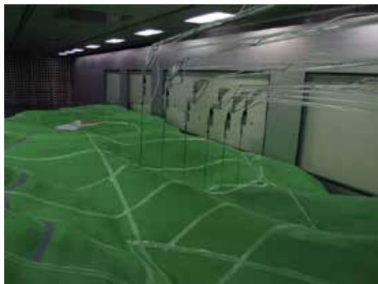
写真9 プロジェクト当時の風洞実験の様子、天井から下がる管が試料ガスの採取管（写真提供：電力中央研究所）
