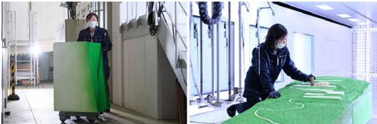
写真7（左）風洞実験用の地形模型は持ち運びや組み替えができるようにブロックに分割されている 写真8（右）プロジェクト当時の地形模型（2ブロック分のみ設置）を風洞内への設置の様子を再現
