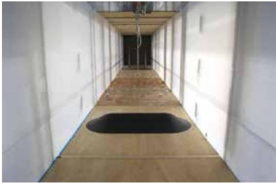
写真 12 単純地形の風洞実験の様子（写真提供：電力中央研究所）
