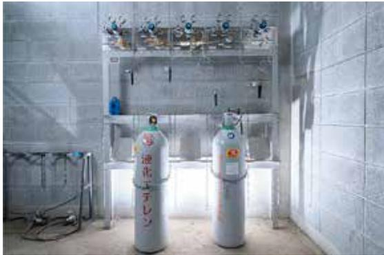
写真6 風洞実験ではエチレンを使用して硫化水素の拡散の様子を再現する
