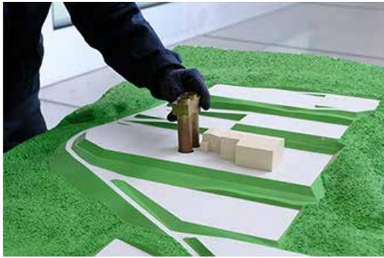
写真5 プロジェクトに使用された風洞実験用模型の一部分。クリーム色の建物が発電所建屋。指先にあるのが冷却塔
