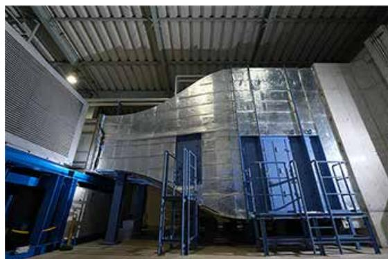
写真4 風洞実験室に安定した風を送るための高さ4.5メートルの巨大な整流部
