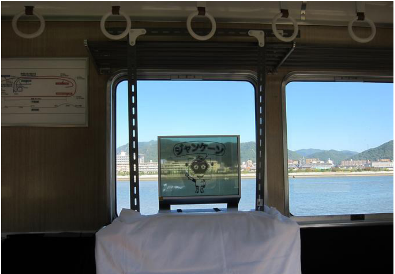
写真 9 スモークガラスではない状態でも検証。約 20 人の被験者による実験が行われ、映り込みやチラツキは気にならなかったという（資料提供：シャープディスプレイテクノロジー株式会社）
