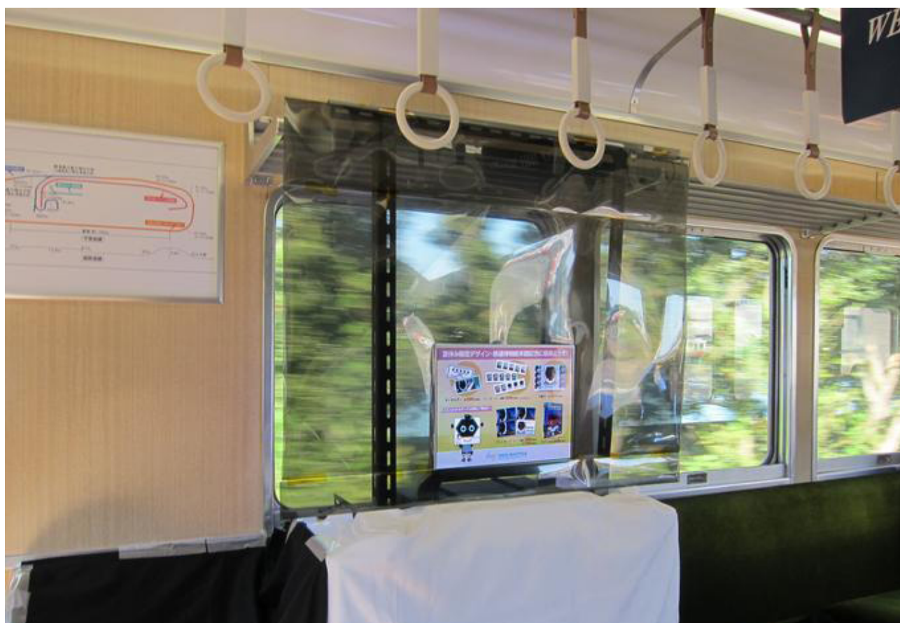
写真 8 三菱重工業の実験線では、窓に透明ディスプレイを設置。楕円形の実験線のため、さまざまな状態の外光が窓から降り注ぐ。この検証では、スモークフィルムを垂らすことで、スモークガラスの場合にどうなるかの検証も行われた（資料提供：シャープディスプレイテクノロジー株式会社）
