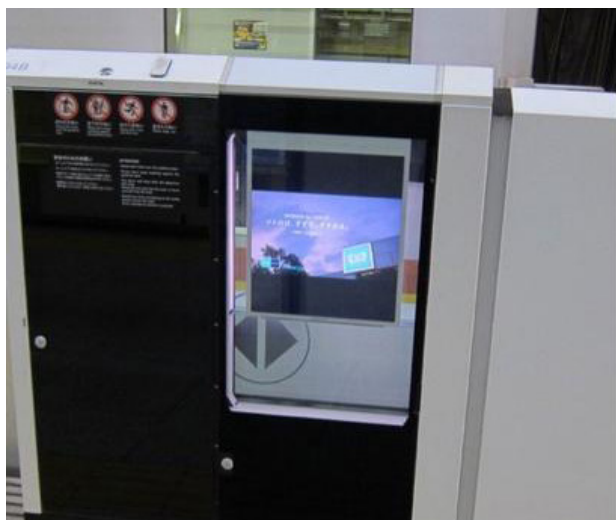
写真 4 豊洲駅の転落防止柵に設置された透明ディスプレイ。カラー表示でちゃんと映像として認識できる（左）。モノクロ表示だと、背景が透けて見えるのがよくわかる（右）（資料提供：シャープディスプレイテクノロジー株式会社）
