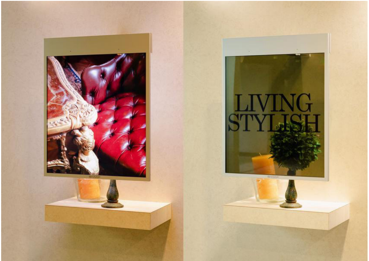
写真 7 シャープミュージアム（奈良県天理市）に展示されている透明ディスプレイ。液晶を使った透明ディスプレイは、外光の影響が少なく、カラー表示でもくっきりとした映像を映し出せる（左）。また透過率は現状低いものの、モノクロ表示では背景を生かした映像表現を可能にしている（右）
