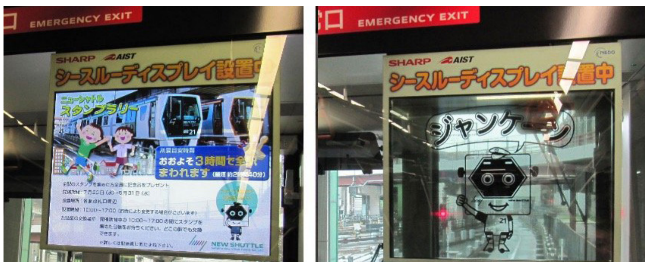
写真5 埼玉新都市交通の運転席扉にある窓ガラスに設置した透明ディスプレイ。カラー表示でも外光があってもきれいに見え、黒色もしっかり出ている（左）。モノクロ表示だと、背景がより一層見えるので、透明感がよくわかる（右）（資料提供：シャープディスプレイテクノロジー株式会社）
