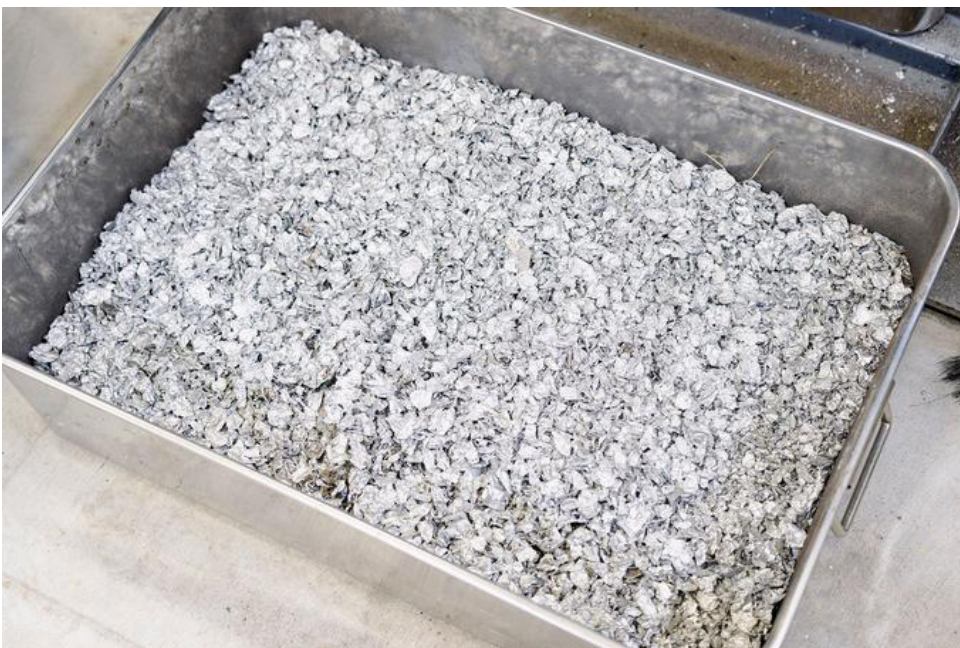
写真 8 乾留炉でプラスチック成分と分離した高純度のアルミ
