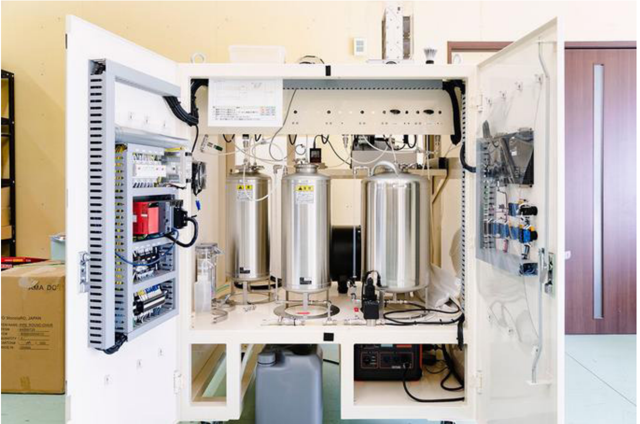
写真 11 エ小僧の内部には、水素を水に通して不純物を除去する「洗浄槽」(左) や、水素を発生させる「反応槽」(中)、反応液を供給する「反応液層」などがある
