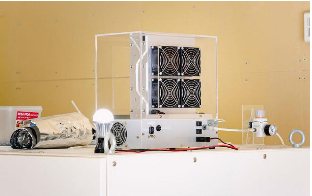
写真 12 実際にアルミ系廃棄物を入れて、水素発電をする「エ小僧」。発電した電力で電球が光っている
