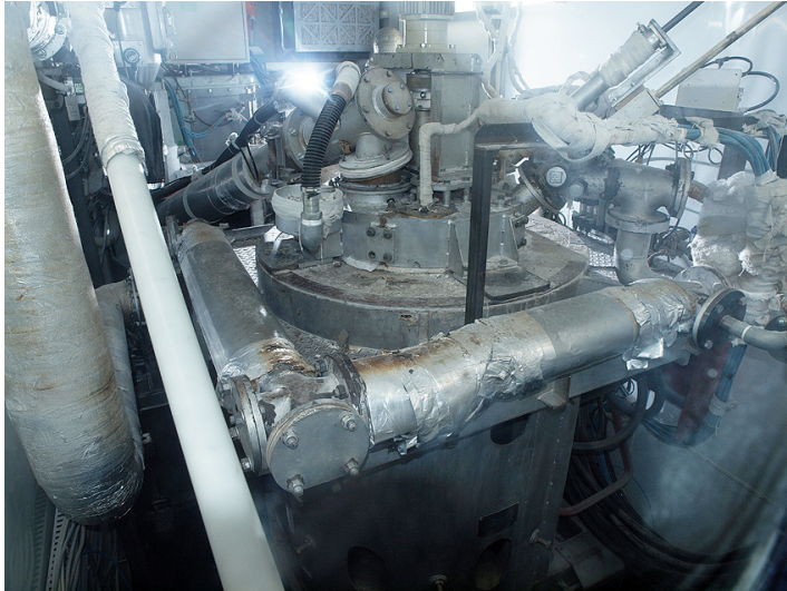
実際に使用されている 150 k w の誘導加熱溶融炉。 トレーラーに収まるよう高さは 1.5m 程度と かなり小型になっている
