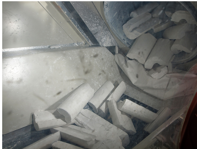
処理システムに投入された配管用保温材。 配管を保温するため中空構造となっており、袋詰め時にかさばる要因となっている。
