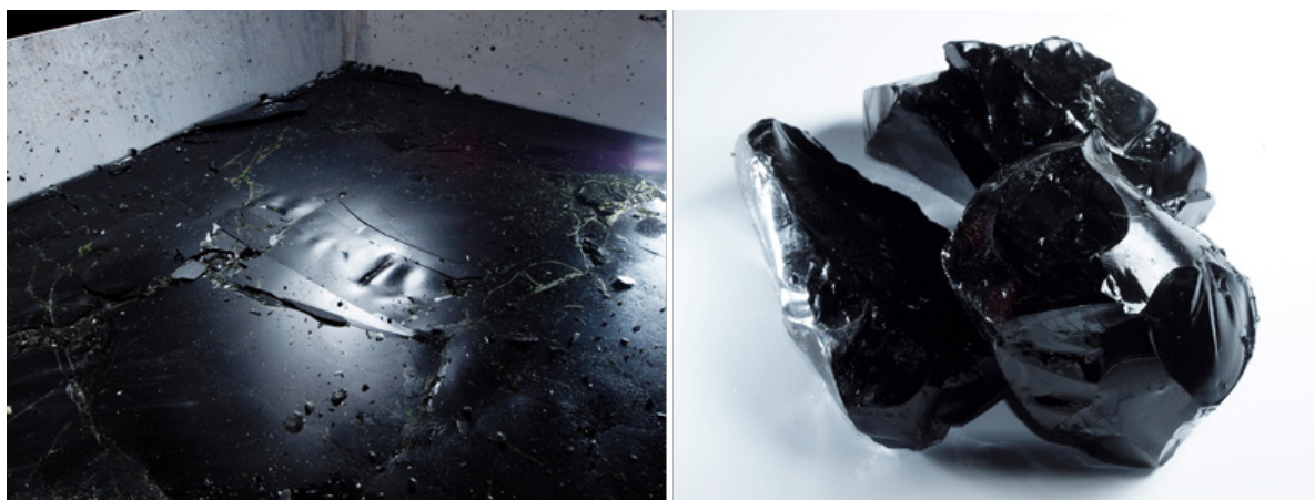
保温材が完全に溶融した後冷え固まった状態で装置から排出されたガラス状の溶融物（左）、 砕けたガラス溶融物。光沢を帯びている（右）
