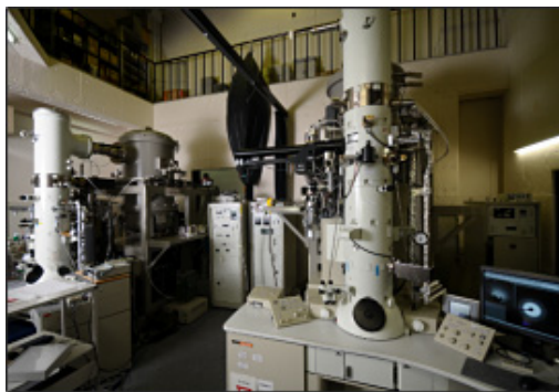
藤吉教授と日本電子が共同開発し、京都大学で使用されている極低温電子顕微鏡
