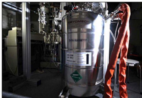
液体ヘリウム回収装置がついた電子顕微鏡
