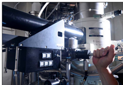
最新の極低温電子顕微鏡の自動試料交換装置
