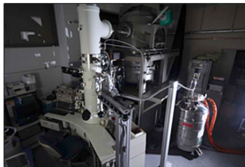
液体ヘリウム回収装置がついた電子顕微鏡
