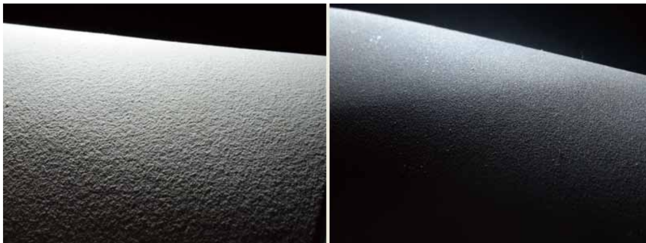
第1段動翼（左）と最後尾（右）ブレードの表面
