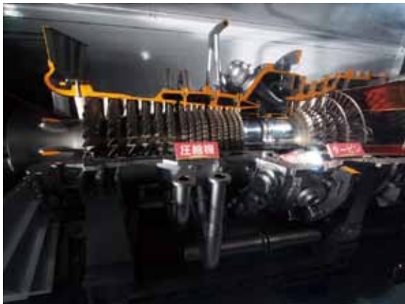
701F型ガスタービンの模型(中央部に圧縮機)
