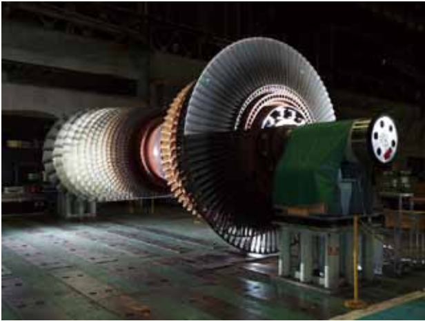
1500℃級ガスタービンのローター（手前がタービン）
