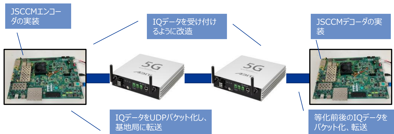
深層学習を用いた送受信器のFPGA実装・ローカル5G基地局の改造
