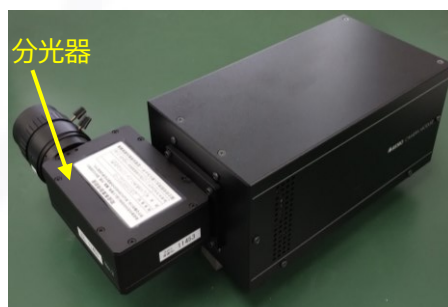
(f)紫外域対応の分光器を取り付けたハイパースペクトルカメラの開発
