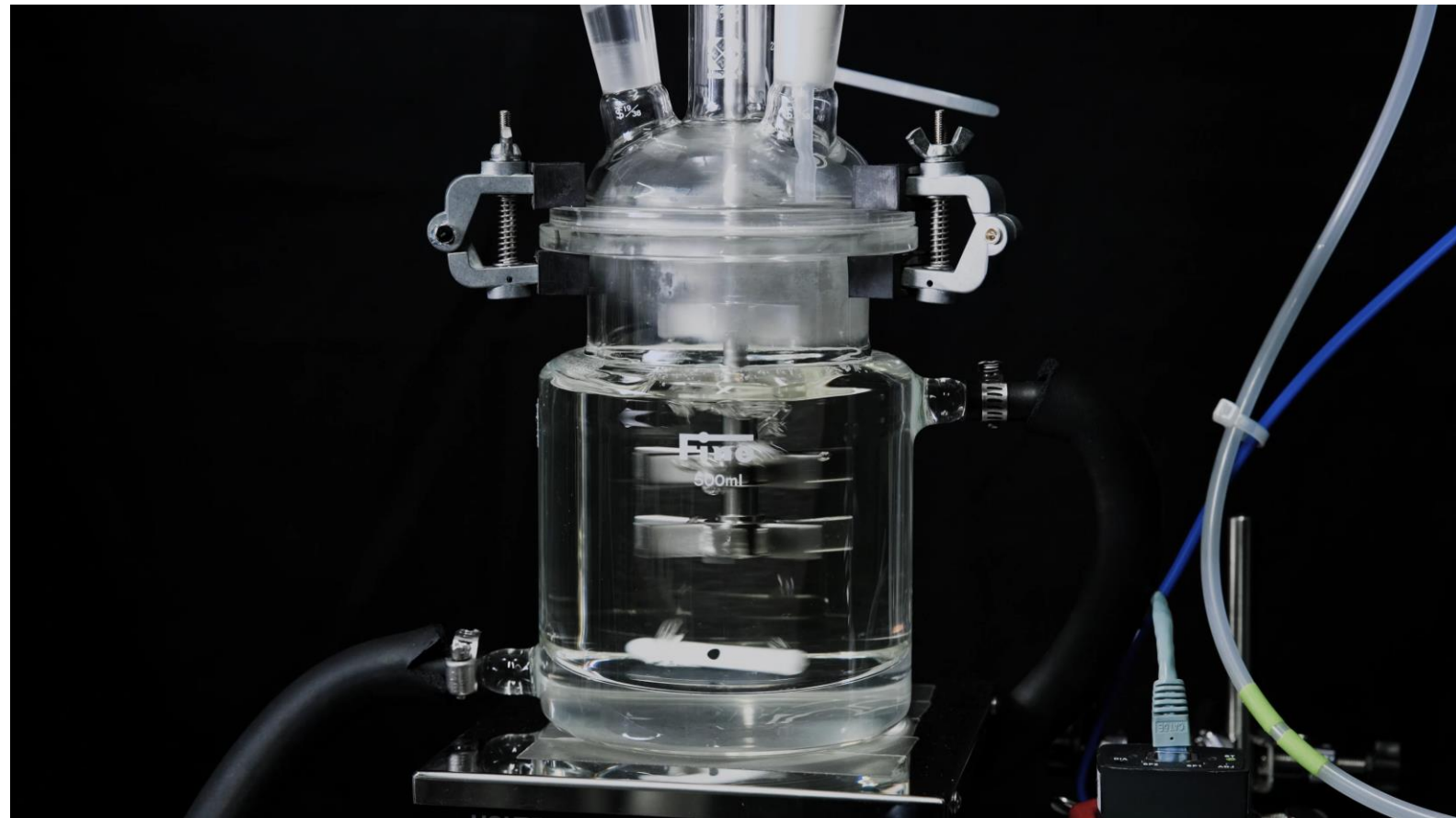
ドライアイスが生成し、シエル側とそれと連結した吸収液容器内の圧力が下がる
