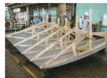
曲げ型を使った測定作業
