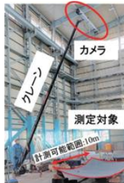
2m×4m板対応 ※計測精度1mm以下を確認
