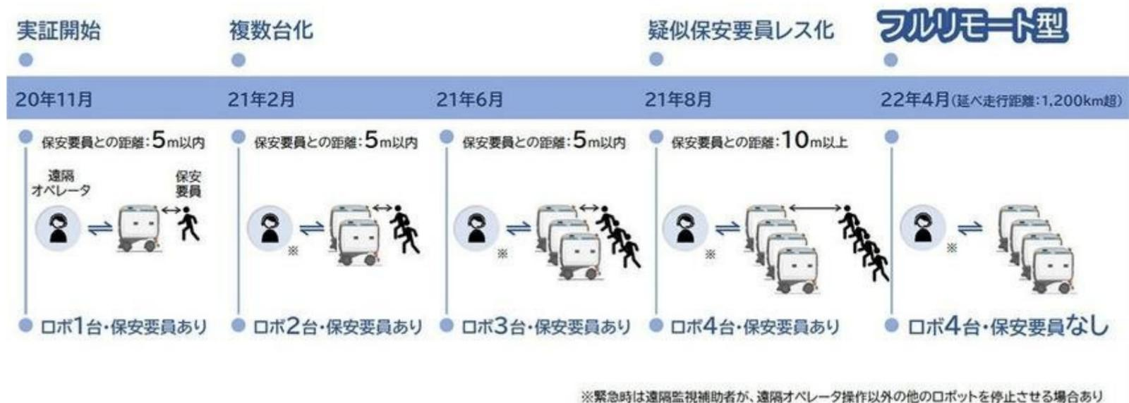
図1 遠隔監視・操作者1名でロボット4台のフルリモート運用を実現(資料提供:パナソニックHD株式会社)
