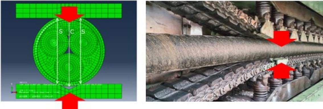
図 4-3-9 側圧の解析モデル
