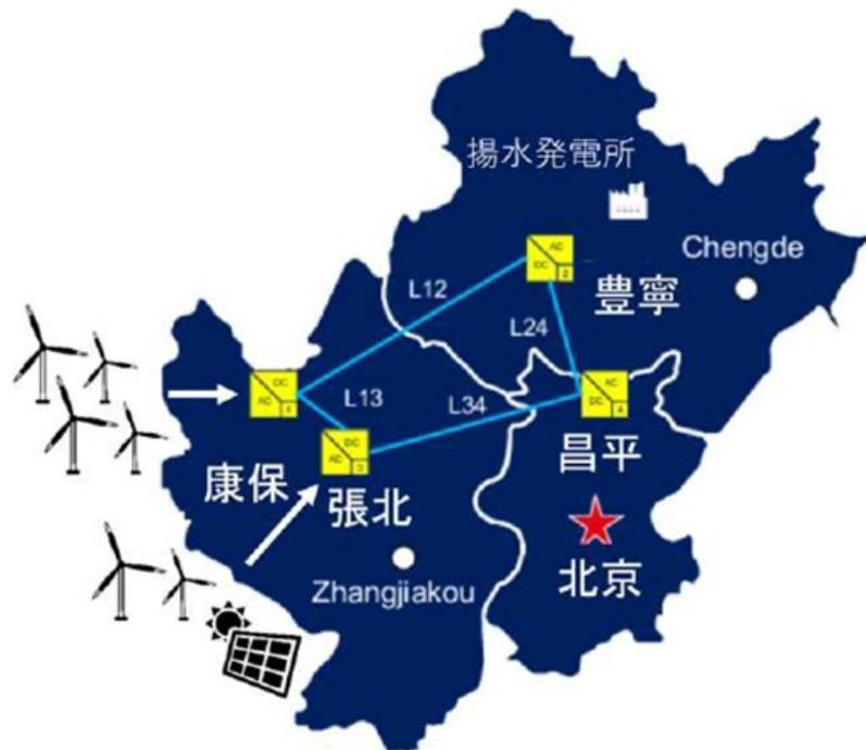
図 1-4-6 張北4端子フレキシブルHVDC送電システム
