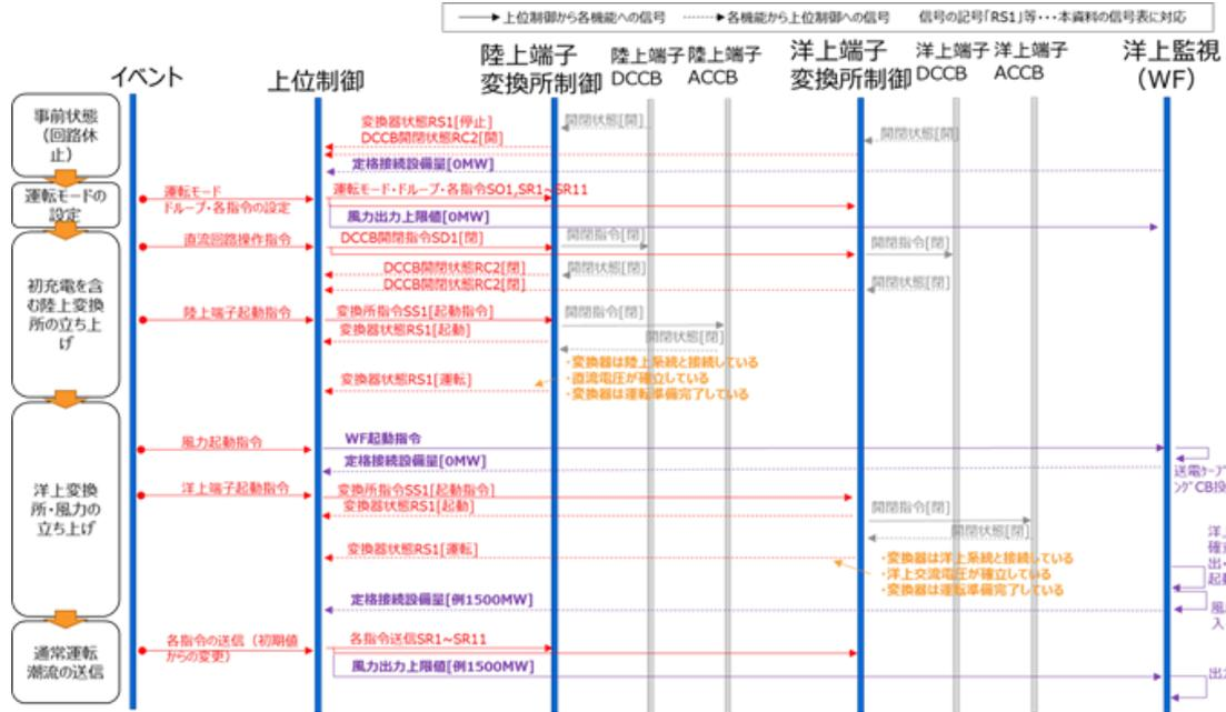
図 4-1-8 直流送電システムと洋上システムの協調シーケンス（システム起動の例）
