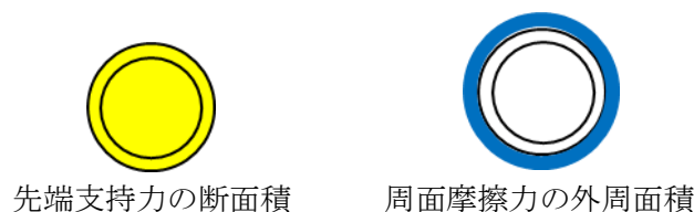
図 5-2 支持力算出の面積(先端開放杭)
