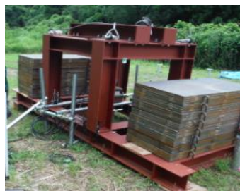
写真 4-2 押込載荷状況
