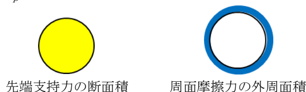
図 5-1 支持力算出の面積(先端閉塞杭)
