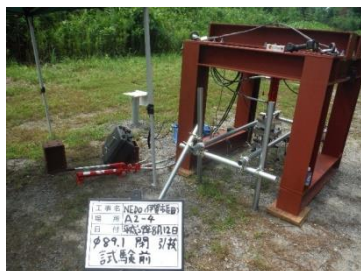
写真 4-1 引抜載荷状況
