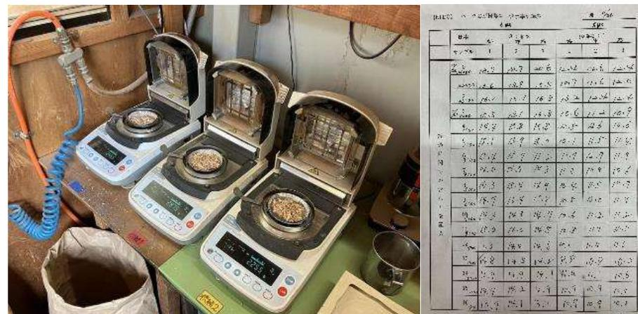
図6. 各3箇所での含水率測定の様子と記録表
