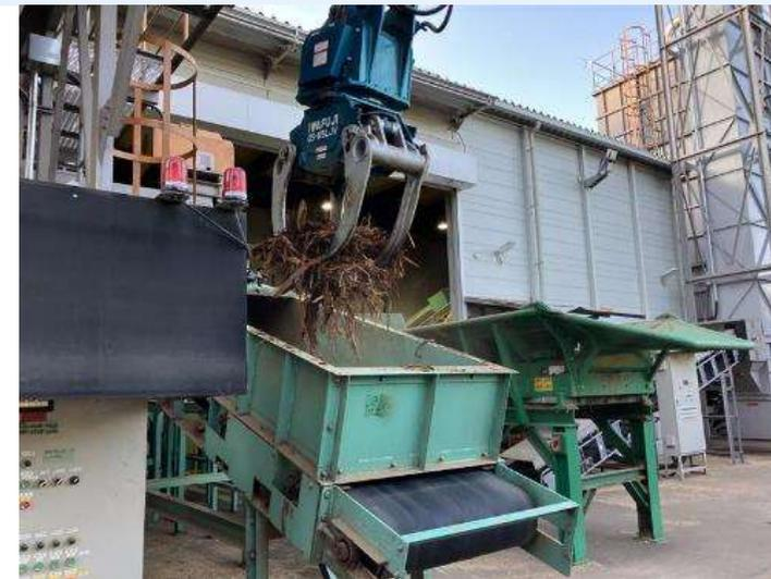
図2. バークを破碎機Bで破碎
