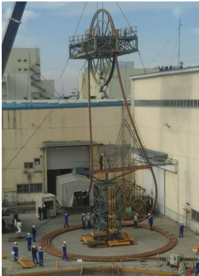
コILING試験の様子（住友電気工業様）
