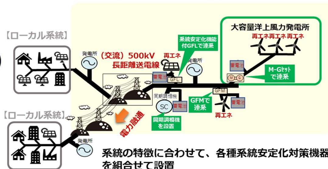
系統の特徴に合わせて、各種系統安定化対策機器を組合せて設置
