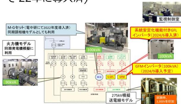
基幹系統を模擬したアナログ型電力系統シミュレータ
