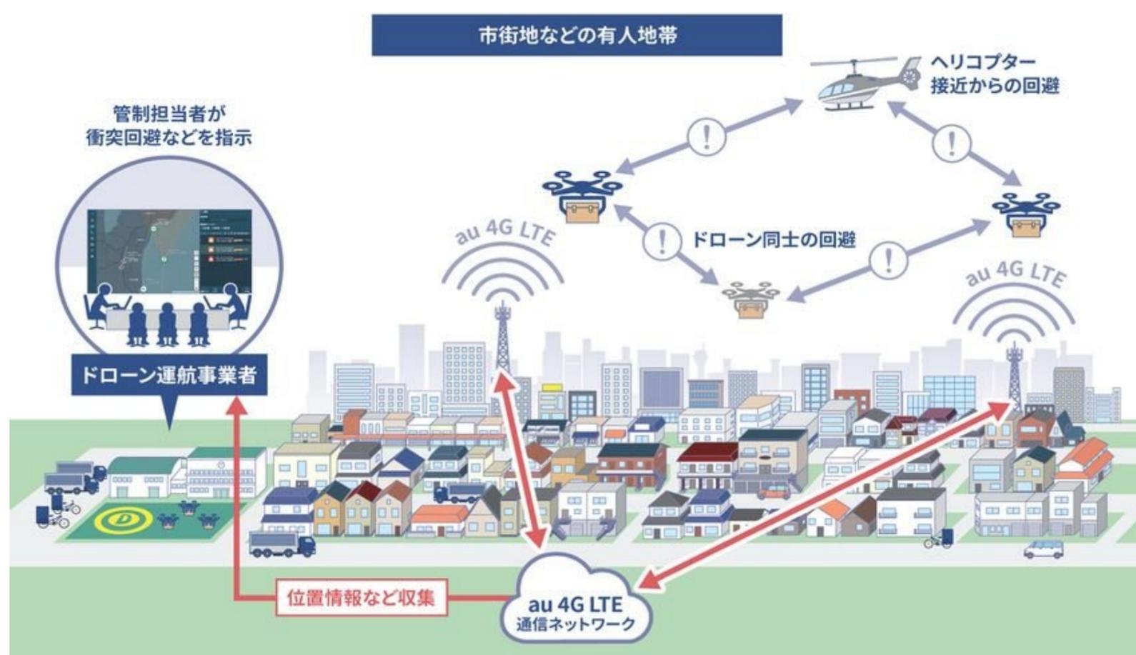
図12 ドローン運航管理システムイメージ図(資料提供:KDDI株式会社)
