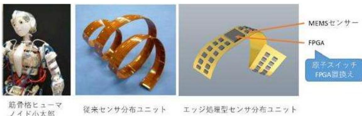
図 4.1.2.3 ヒューマノイドロボット小太郎と搭載されている 64 個の触覚センサ
