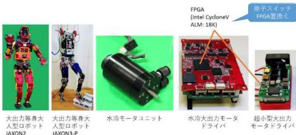
図 4.2.1.1 大出力等身大人型ロボットにおいてトルク制御用に用いられるモーターおよび FPGA を含むドライバー
