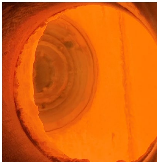
気体アンモニア燃焼状況 (火炎は耐火材の発色と重なり 目視できない)
