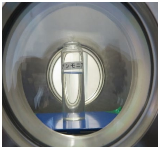
写真：液体アンモニア(25℃, 1MPa)
