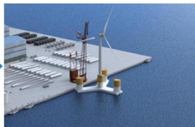
風車搭載時の喫水が3~5mのため港湾内での風車搭載が可能
